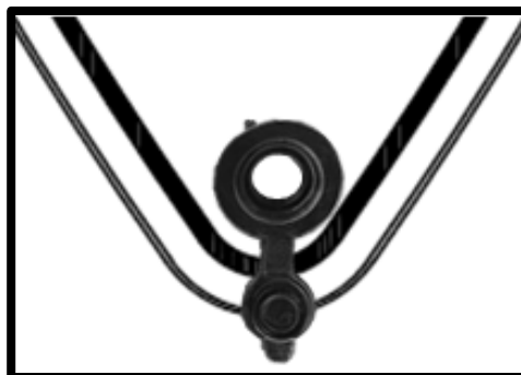
Figura 10 - Detalhe do bico de drenagem para esvaziamento do líquido das vestes.
